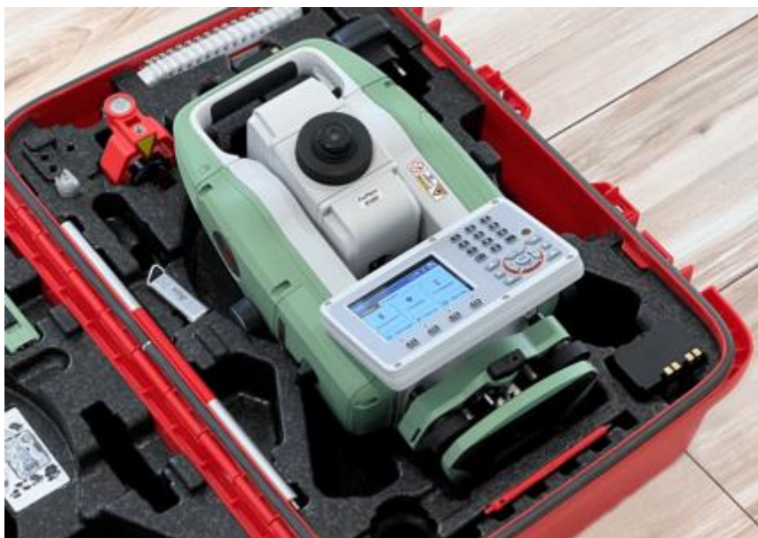
Рисунок 18- Комплектующие Leica TS07
